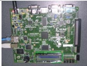
Fig. 10. Spartan 3E XC3S500E FPGA.
